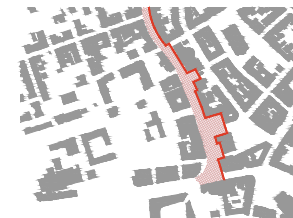
Sířší vztahy - ul. Nádražní s proměnlivou stavební čarou
