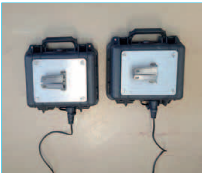
Přenosný radarový sčítač TMS-SA4 (nabíjení)
