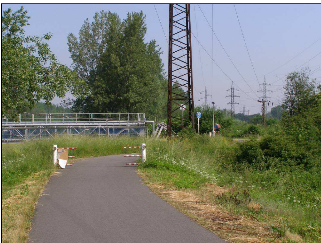
Příklad zábran proti vjezdu na stezku
