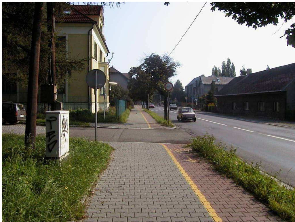
Příklad jednosměrné dělené stezky pro chodce a cyklisty (chybějící reliéfní dlažba)
