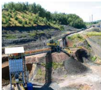
Hlušinu přivádějí k lince kilometry pásových dopravníků. Foto: B. Krzyžanek
