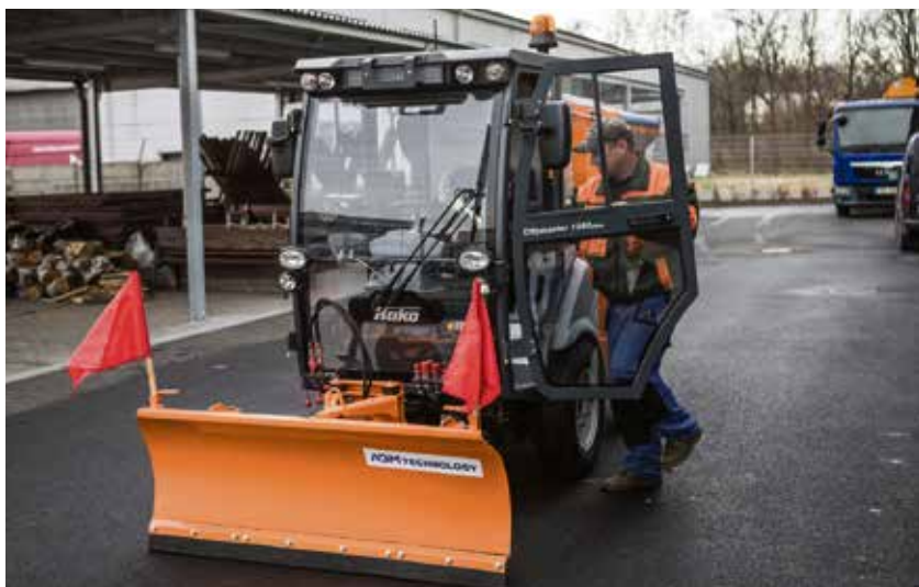
Prachožrout má vyměnitelné vybavení, nyní má nasazenou radlici na sníh, v létě bude mít kartáče na prach. Foto: Jiří Zerzou
