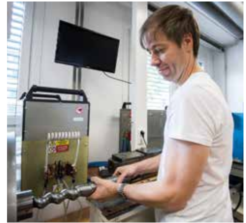
Radim Koch při práci na stroji pro rotační kování. Radim Kocich using a rotary forging machine.
